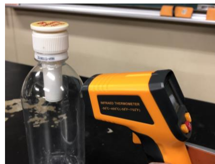
図6 赤外線温度測定器を用いた測定
