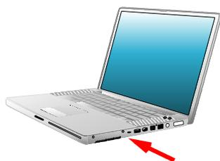
電子黒板は映像端子の近くにRCA端子（ピン端子）を、PCはヘッドフォンのマークのついている接続口にミニピンジャック端子を差し込みます。
