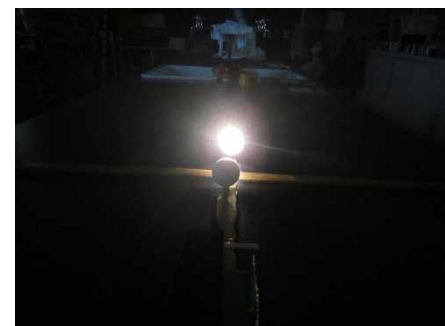
図3 月の満ち欠けの実験装置(感光器のせ台は自作)
